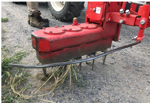
Désherbage mécanique : visite chez un producteur utilisant le cultivateur Intercepts sur relevage avant de Cuchi.
